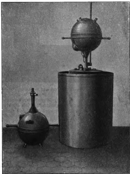
Bild 12 50 m³ Warmvergaser bei der Füllung mit Vakuumgefäßen.
