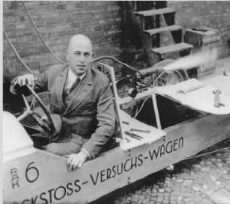
Bei den Heylandt-Versuchen in Britz glaubt man noch an die damals weit verbreitete Meinung, Flüssigtreibstoff-Raketentriebwerke können nicht explodieren, ein Irrtum, den Valier mit seinem Leben bezahlen sollte. Rechts: Der Aufbau von Valiers Triebwerk mit Sauerstoffdüsen am Boden, der Wirbelscheibe und der Gegenstrom einspritzung von Alkohol ist hier gut zu erkennen. Die zylindrische Brennkammerwand mit der Düse oben sind hier entfernt.
