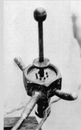
Bei den Heylandt-Versuchen in Britz glaubt man noch an die damals weit verbreitete Meinung, Flüssigtreibstoff-Raketentriebwerke können nicht explodieren, ein Irrtum, den Valier mit seinem Leben bezahlen sollte. Rechts: Der Aufbau von Valiers Triebwerk mit Sauerstoffdüsen am Boden, der Wirbelscheibe und der Gegenstrom einspritzung von Alkohol ist hier gut zu erkennen. Die zylindrische Brennkammerwand mit der Düse oben sind hier entfernt.
